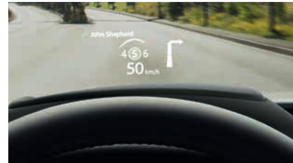
Проекційний дисплей на вітровому склі
