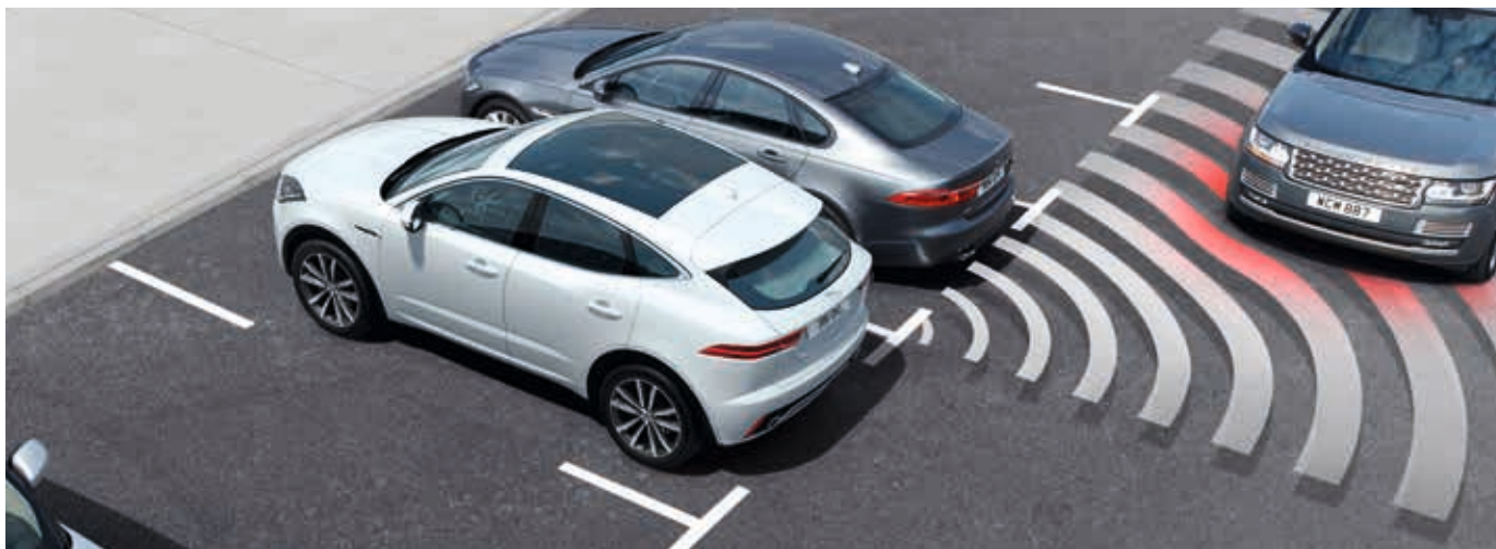
Функція контролю руху заднім ходом Rear Traffic Monitor
