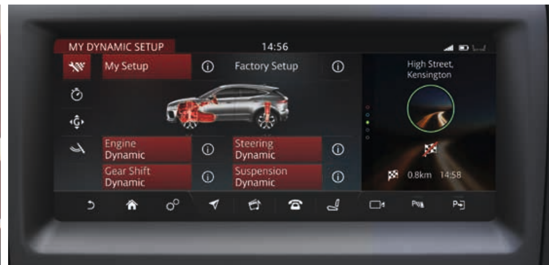
ДИНАМІЧНИЙ РЕЖИМ ТА СИСТЕМА ДИНАМІЧНОГО УПРАВЛІННЯ ПІДВІСКОЮ (CONFIGURABLE DYNAMICS)
